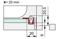
d) mit Dichtprofil 8861KU0-8 und Türanschlag-Trägerprofil 8880
