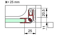
c) mit Dichtprofil 8855KU0-8 und Türanschlag-Trägerprofil 8880
