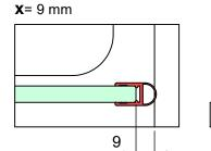
b) mit Dichtprofil 8851KU0-8 und Türanschlag-Trägerprofil 8880
