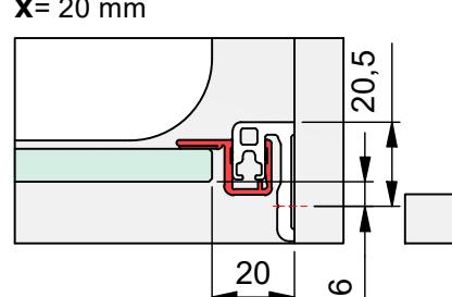
d) mit Dichtprofil 8861KU0-8 und Türanschlag-Trägerprofil 8880
