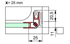
c) mit Dichtprofil 8855KU0-8 und Türanschlag-Trägerprofil 8880
