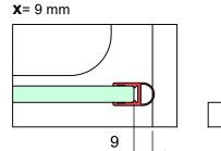
b) mit Dichtprofil 8851KU0-8 und Türanschlag-Trägerprofil 8880
