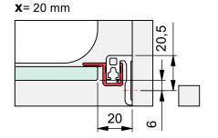
d) mit Dichtprofil 8861KU0-8 und Türanschlag-Trägerprofil 8880
