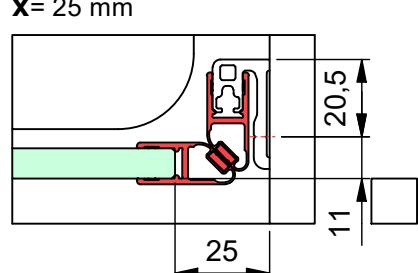
c) mit Dichtprofil 8855KU0-8 und Türanschlag-Trägerprofil 8880
