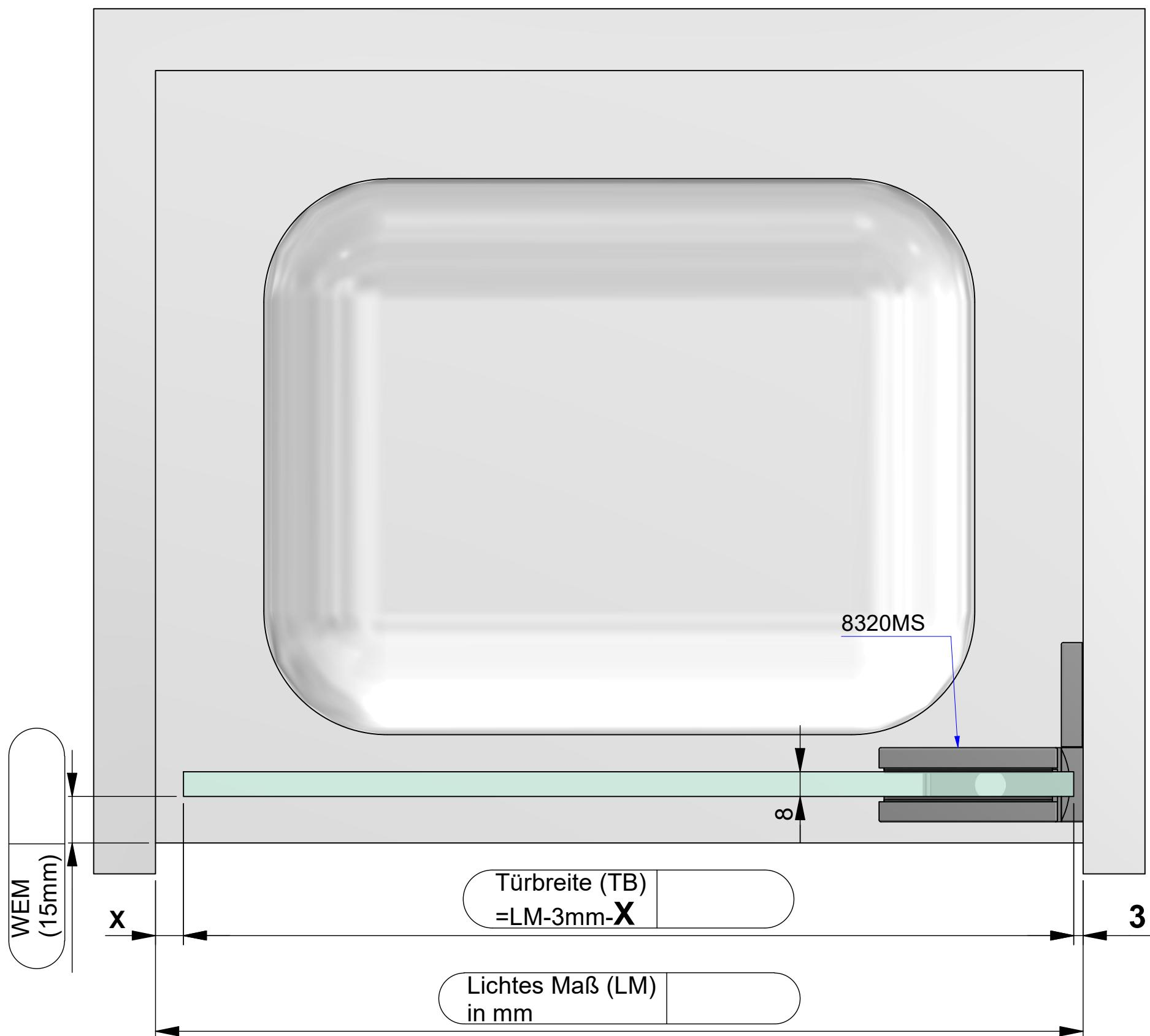
**Dichtungslösung Griffseite:**a) mit Dichtprofil 8861KU0-8
