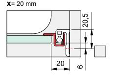
d) mit Dichtprofil 8861KU0-8 und Türanschlag-Trägerprofil 8880
