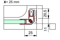
c) mit Dichtprofil 8855KU0-8 und Türanschlag-Trägerprofil 8880
