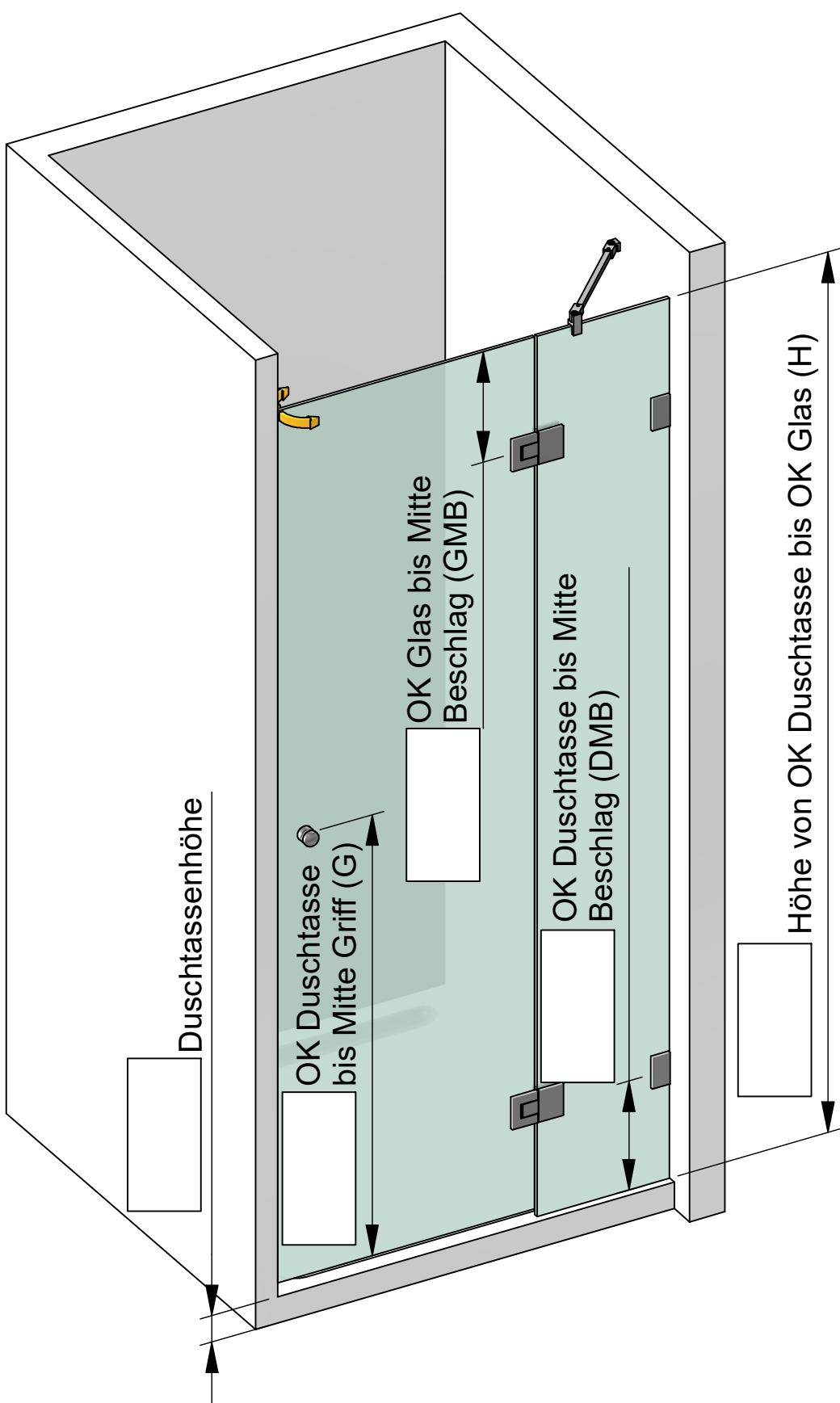
Die hier dargestellte Verwendung von Stabilisationsstangen ist als Beispiel anzusehen. Größe und Position der Stabilisationsstangen ist abhängig von der Glasgröße!
