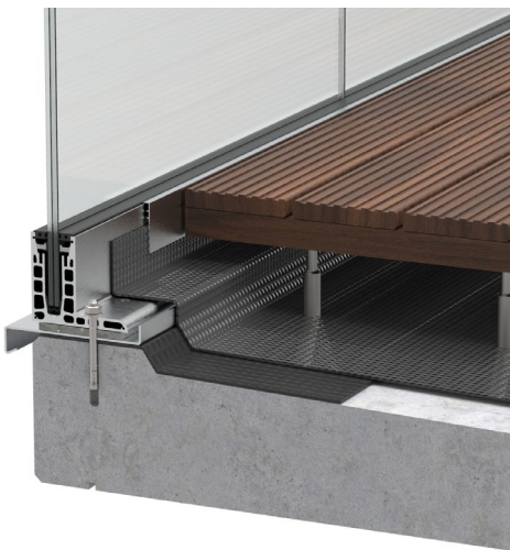
(A) Außenanwendung: Beispiel Balkon mit Betonelementen, Gefälle nach innen exterior application: example balcony with concrete elements, slope inwards
