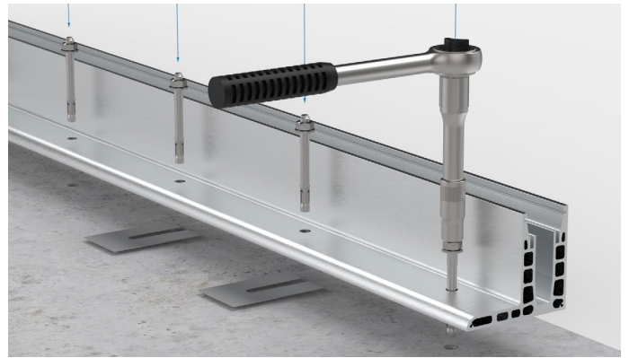
1. Profil anschrauben | mount the profile
