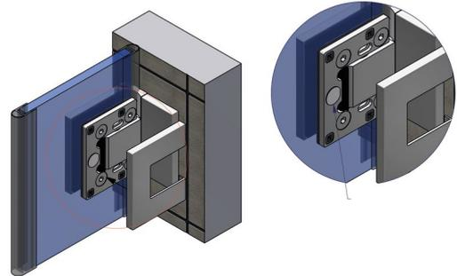
7) Zur Fixierung der Abdeckkappen 8320-9MS, diese mit den Zapfen in die vormontierten EPDM-Formteile stecken und andrücken.
