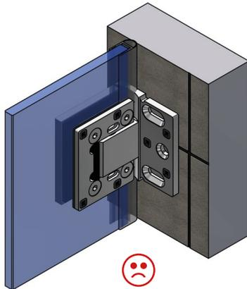
2) Um ein Kippen der Drehachse zu verhindern, sollte das Duschtürband immer vollflächig auf einer Fliese montiert werden!
