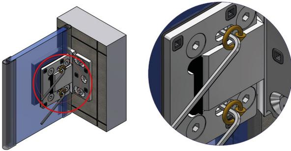
4) Wenn der Türflügel ausgerichtet ist und alle Dichtprofile aufgesteckt wurden kann die Nulllage eingestellt werden. Dabei sind die Gewindestifte wechselweise auf das angegebene Anzugsmoment anzuziehen und nach ca. 15 Minuten nachzuziehen. Hierzu sollte ein hochwertiger abgewinkelter Innensechskantschlüssel SW2,5 verwendet werden.
