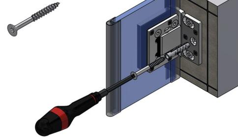
5) Ist die Dusche fertig aufgebaut und ausgerichtet, können die Bänder endgültig fixiert werden. Das Duschband ist so konstruiert, dass die Befestigungsbohrung mit einem 8mm Bohrer im montierten Zustand ausgeführt werden kann.
