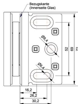
Je nach verwendetem Dichtprofil ist darauf zu achten, dass unterschiedliche Glasbearbeitungen zum Einsatz kommen. Achtung: alle Maße beziehen sich auf 8 mm Glas
