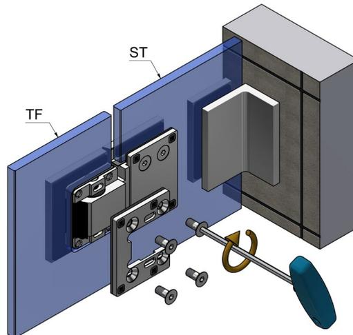
2) Wichtig: Schrauben und Dübel müssen an die jeweilige bauliche Situation angepasst sein! Der Bohrer ist entsprechend der Größe der Dübel zu wählen. Die Schrauben sollten aus Edelstahl A2 oder A4 bestehen und einen Senkkopfdurchmesser von 10mm und max. 12mm aufweisen.
