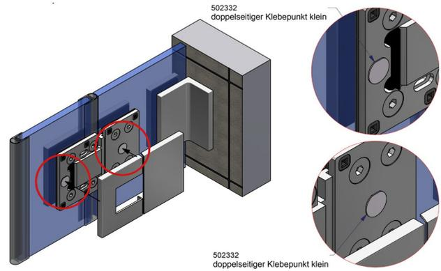
4) Je nach verwendetem Dichtprofil ist darauf zu achten, dass unterschiedliche Glasbearbeitungen zum Einsatz kommen.
